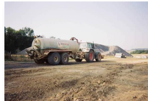
Photo 204 : Arrosage des pistes de chantier
