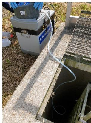
Prélèvement d'eau dans ouvrage de fuite d'un bassin d'assainissement
